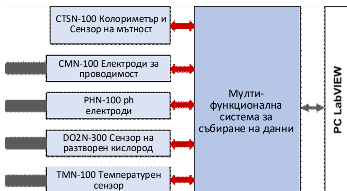
Фиг. 5.5. Блок схема на разработената виртуална система за анализ на вода (Nikolov, Marinov, Ruskova, & Gieva, 2017)
