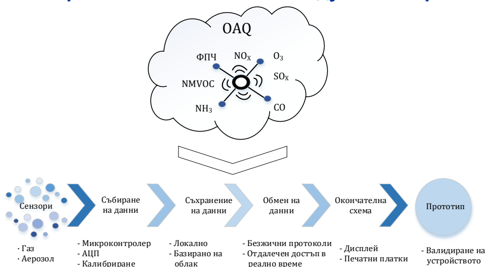
Фиг. 2.1. Графично представяне на основни стъпки при реализация на устройства за изследване на качеството на въздуха на открито
