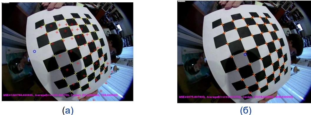
Фиг. 3.26. Резултати от калибрирането с помощта на софтуера OCamCalib. (а) Пример за неправилно определяне на параметрите на калибриране (Scaramuzza, Martinelli, & Siegwart, 2006); (б) Пример за правилно определяне на параметрите на калибриране
