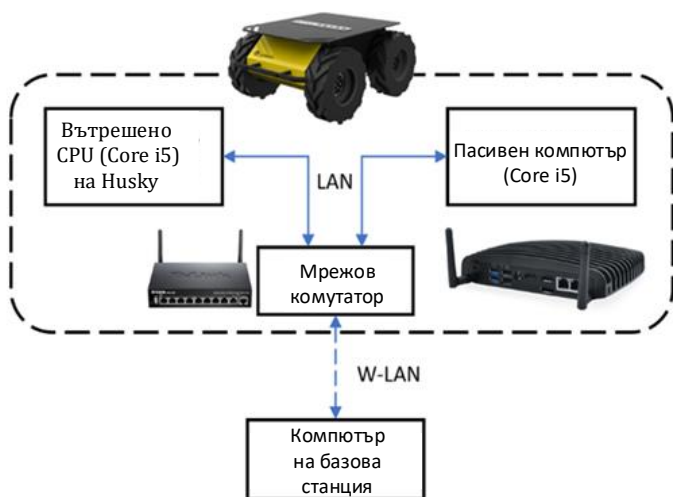
Фиг. 7.4. Платформа Husky с допълнителен процесор и базова станция (преносим компютър).
