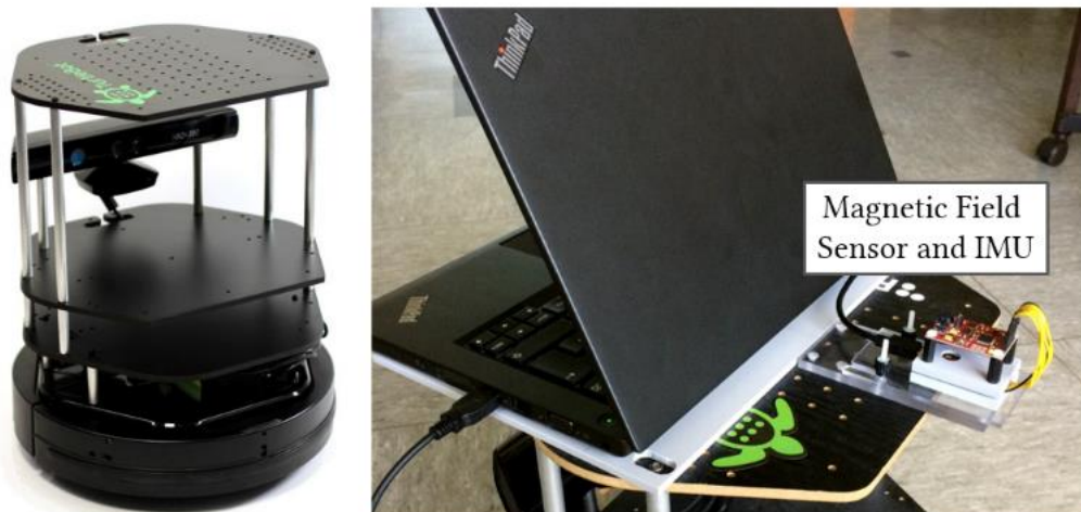
Фиг. 7.24. Платформа за мобилен робот (вляво) и експериментална уредба, комбинирана със сензор за магнитно поле IMU (вдясно)
