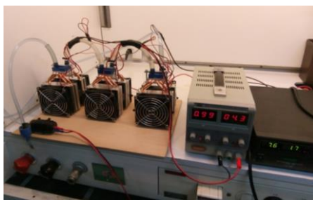
Фиг. 4.10. Модул за охлаждане на електролит за анодиране по време на разширяване на диаметъра на ААО нанотръбичките.
