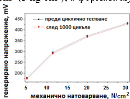
Фиг.2.13. Сравнение на генерираното напрежение от гъвкави генератори с \text{KNbO}_3 преди натоварване и след 1000 цикъла на огъване.
