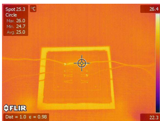
Фиг. 4.24. Термографски снимки на метализираните отвори при писта с ширина 0,245 μm
