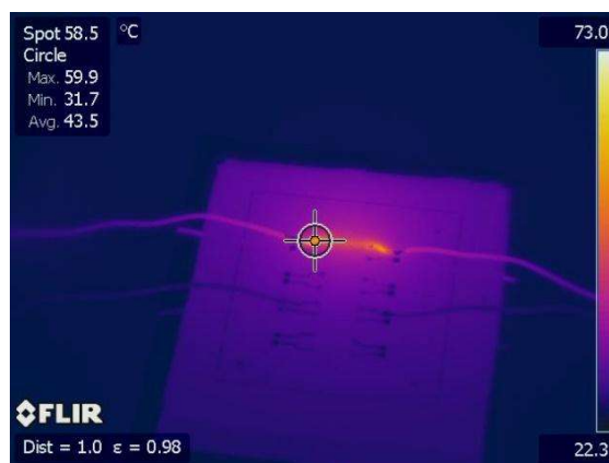
Фиг. 4.24. Термографски снимки на метализираните отвори при писта с ширина 0,245 μm
