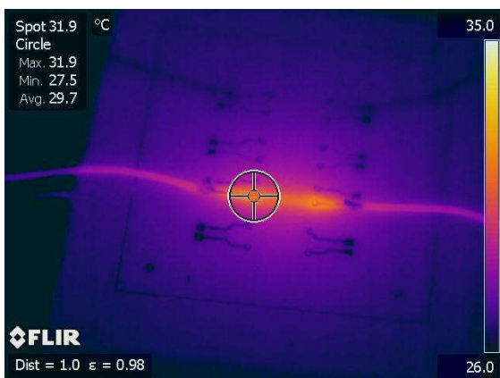
Фиг. 4.25. Термографски снимки на метализираните отвори при писта с ширина 0,470 μm
