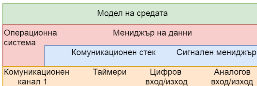
Фиг.4.11. Архитектура на симулатор
