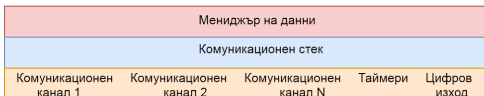
Фиг.4.6. Софтуерна архитектура на мениджър на симулацията
