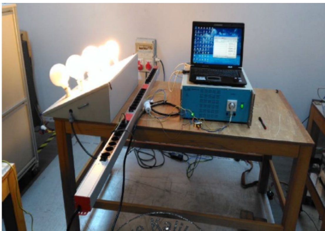
Фиг. 56. Изпитване на устойчивост на хармоници и Фликер шум
