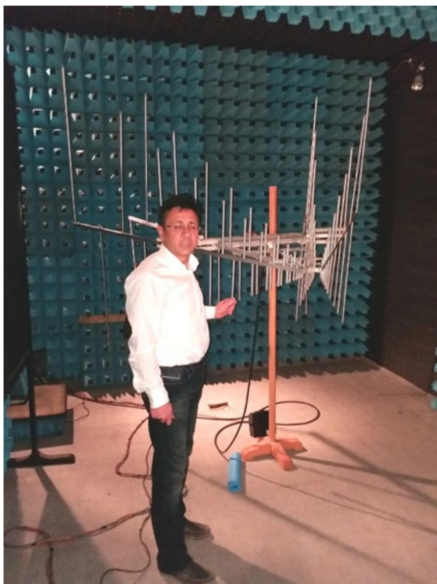
Фиг. 54. Изпитване на устойчивост на излъчвани смущения
