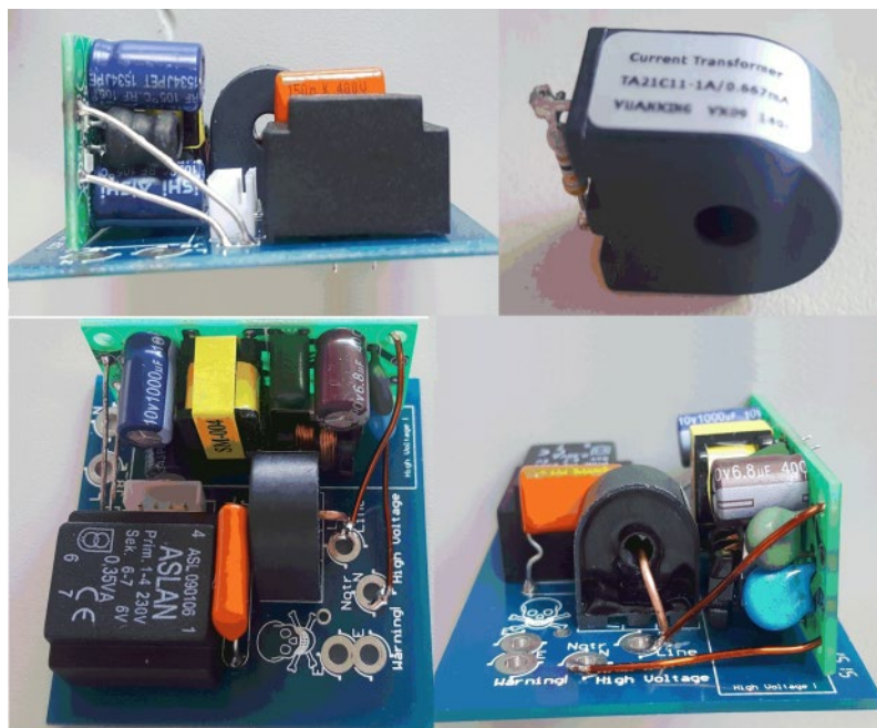
Фиг. 18. Реализация на входните вериги и захранването на IP-PDU устройства
