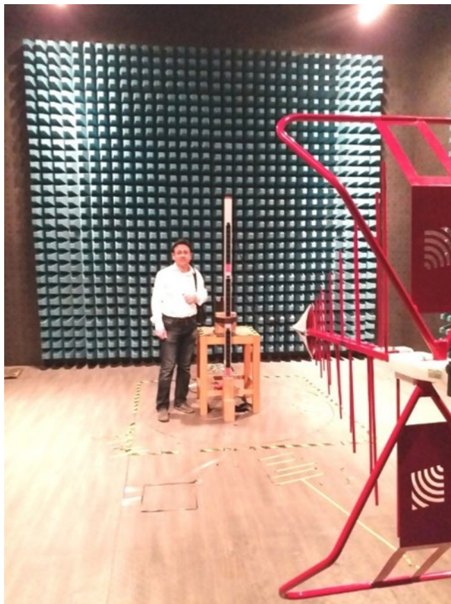
Фиг. 52. Изпитване за излъчени емисии
