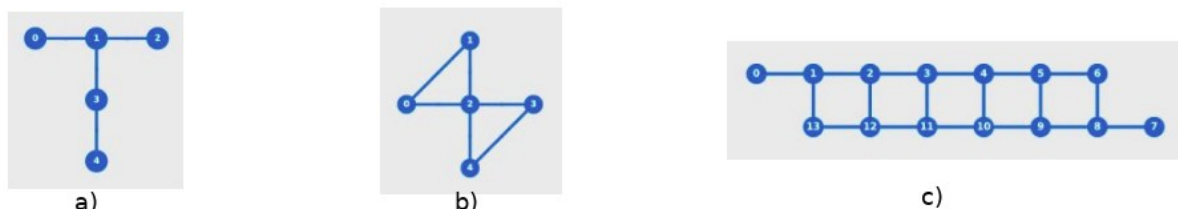
Фигура 16. Конфигурационни карти на квантовите процесори в облачната платформа на IBM, върху които е извършена експерименталната проверка и валидация.
