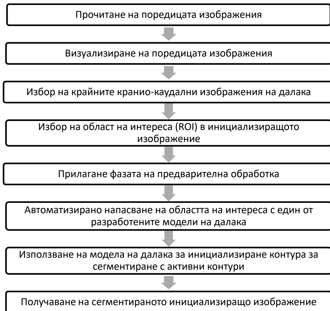
Фиг.5.1 Блок схема на алгоритъма за сегментацията на далака в инициализиращото изображение [А.Михайлова]
