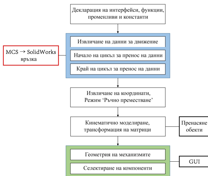
Фигура 3.12. Структура на VBA-базираното SolidWorks макро приложение.
