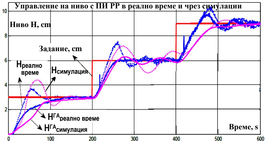
Фиг. 3.8. Преходни процеси на нивото при управление с ПИ РРи
