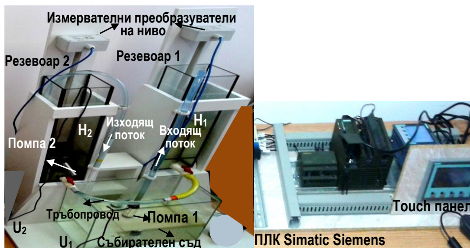
Фиг. 5.10. Експериментална постановка за управление в реално време на нивата на течност в свързани резервоари с РР-ПРК, реализиран в ПЛК
