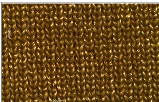
Фигура 5. Структура на контактната повърхност (електроди без кант)
