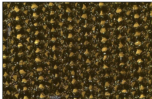
Фигура 6. Структура на неkontaktната повърхност (електроди без кант)
