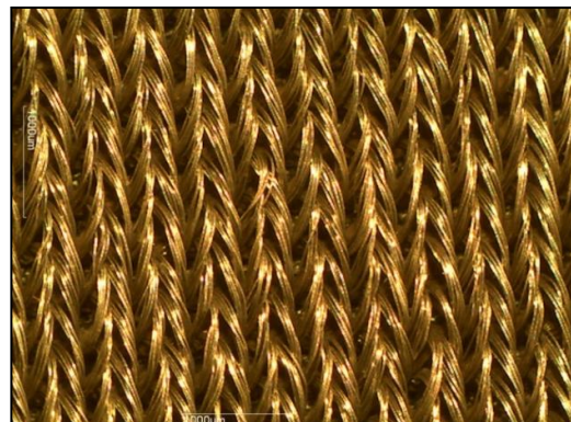
Фигура 8. Структура на контактната повърхност (електроди с кант)
