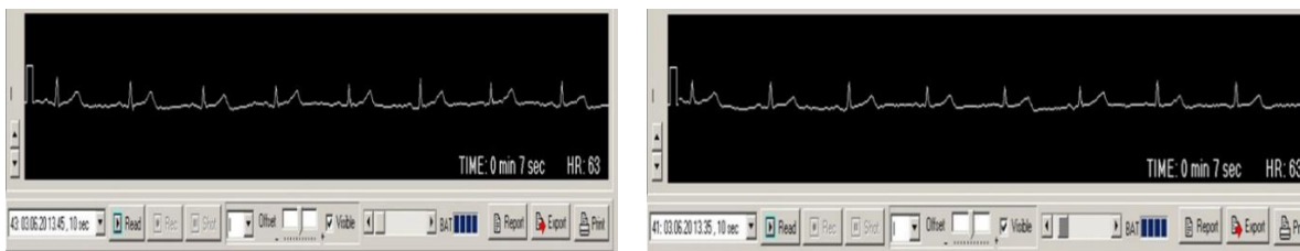
Фигура 23. ЕКГ запис на пациент, реализиран с помощта на текстилни електроди с кант (необработени и след 10 цикъл на пране)
