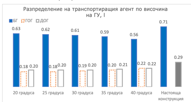
Фиг. 7.5. Разпределение на транспортиращия агент по височина на горивната уредба при настоящата конструкция на прахоконцентратор и при различен наклон на лопатките на новата конструкция.
