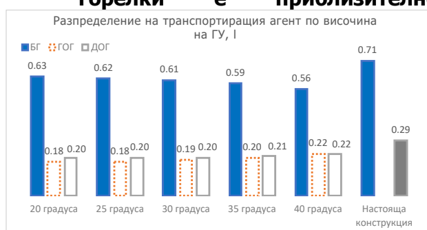
Фиг. 7.6. Разпределение на въглищния прах по височина на горивната уредба при настоящата конструкция на прахоконцентратор и при различен наклон на лопатките на новата конструкция.
