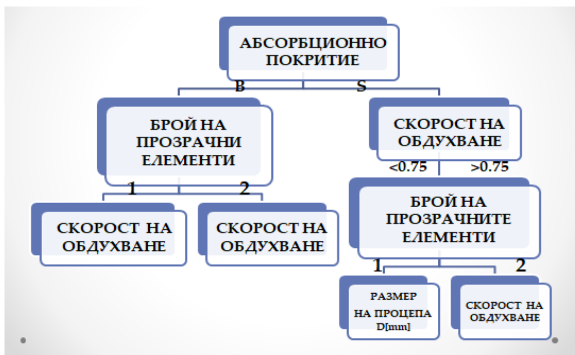
Фиг.4-1 (4.3.1.А-15а) Ранг на значимост на факторите при принудена вентилация
