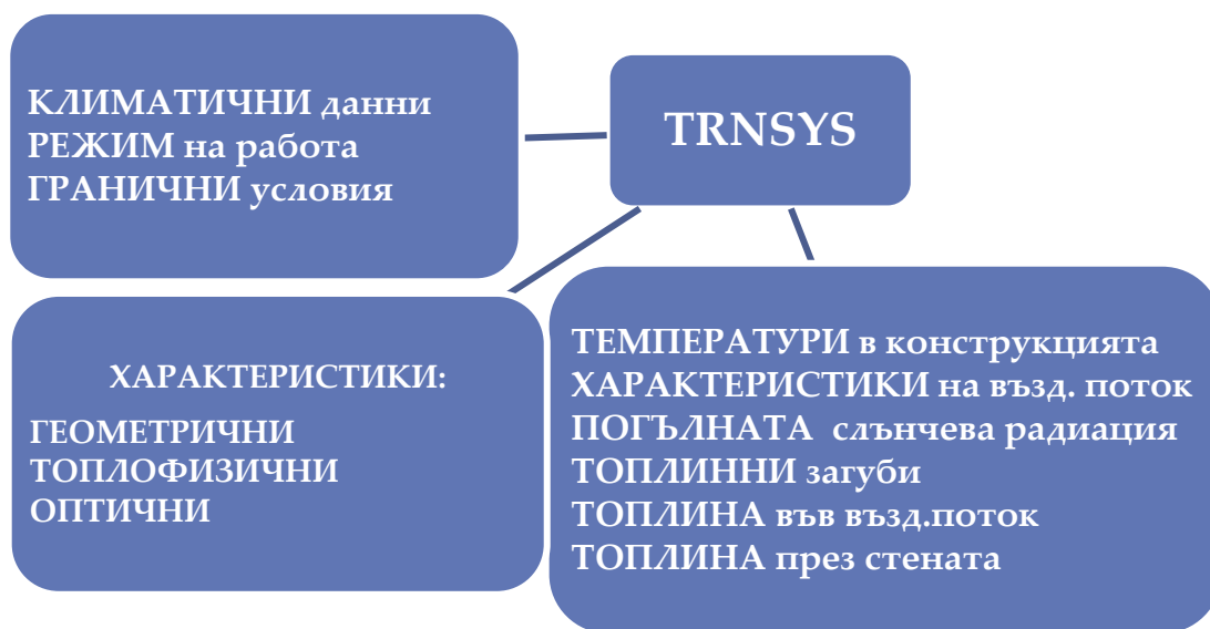
Фиг.3-4 (3.3.2-3) Входящи и изходящи параметри в модел на стена на Тромб
