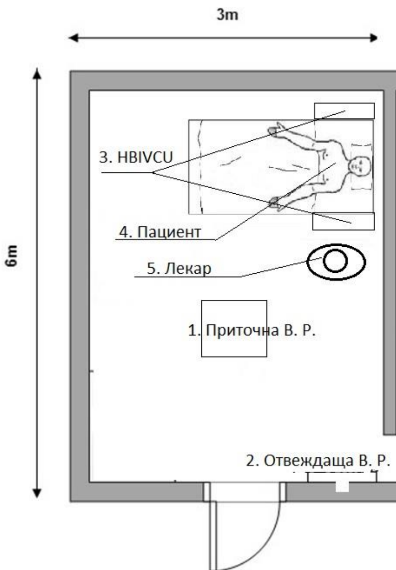
Фигура 2.1 Схема на опитната постановка: 1 – Приточна Въздухоразпределителна Решетка (В. Р.); 2 – Отвеждаща Въздухоразпределителна решетка; 3 – HBIVCU система (локална вентилация); 4 – Пациент; 5 – Лекар
