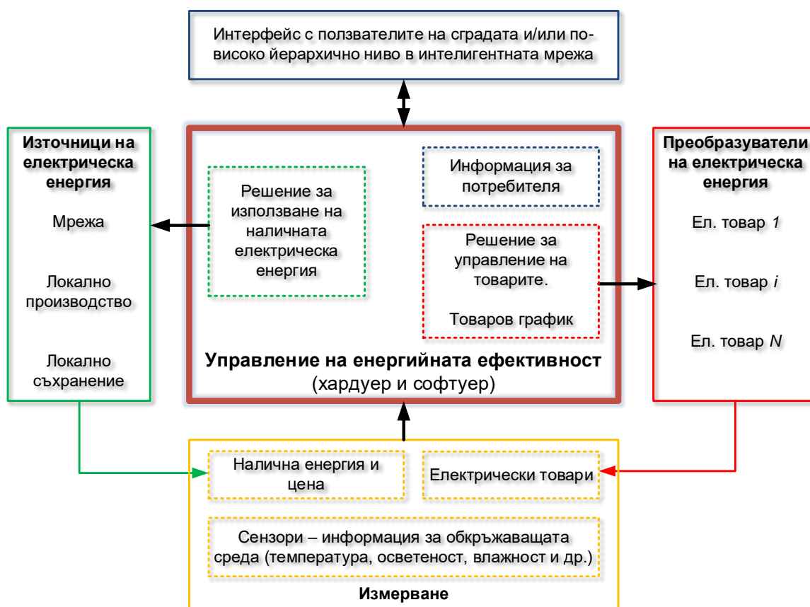
Фиг. IV-2 Принципна схема за управление на енергийната ефективност на дома
