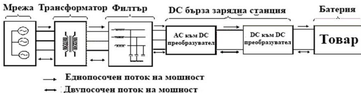
Фиг. II-2 Блокова схема на DC бърза зарядна станция
