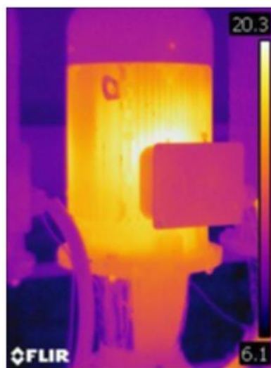
Фиг. 2.23. Термографско изображение след прилагане на нискочестотен филтър на средната стойност
