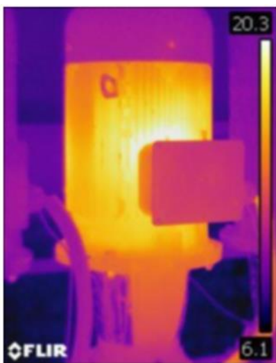
Фиг. 2.22. Термографско изображение след прилагане на Гаусовия нискочестотен филтър
