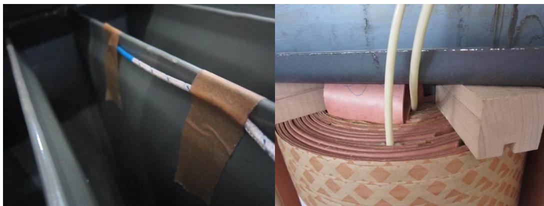
Фиг. 5.3. Инсталиране на термодвойките.
