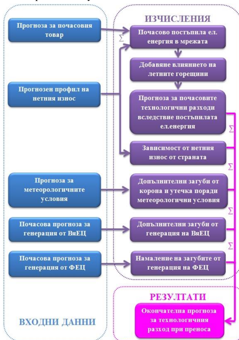
Фигура 27. Поток на данните, последователните пресмятания и получаване на резултатите в модела за прогнозиране на почасовите технологичните разходи в електропреносната мрежа.
