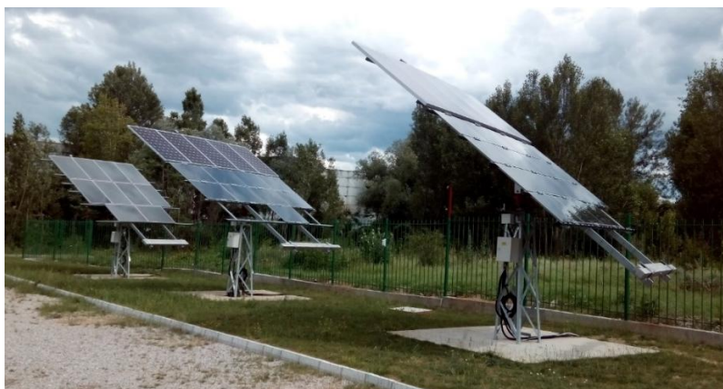
Фиг. 3.3 Слънцеследящи системи с монтирани ФВ модули.
