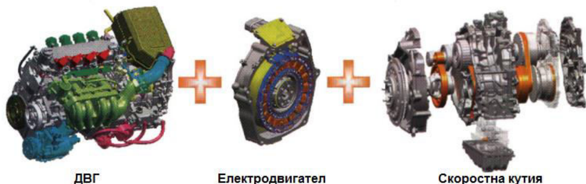
Фиг. 1.3 Електродвигател присъединен към вала на ДВГ
