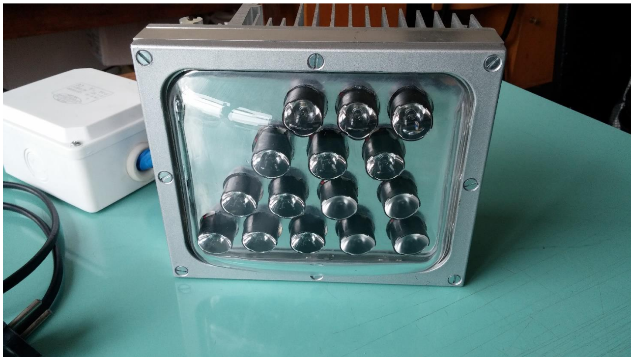
Фиг. 4.21. Общ вид на разработения осветител от тип "Flat Beam" за входната и преходната зони на пътен тунел
