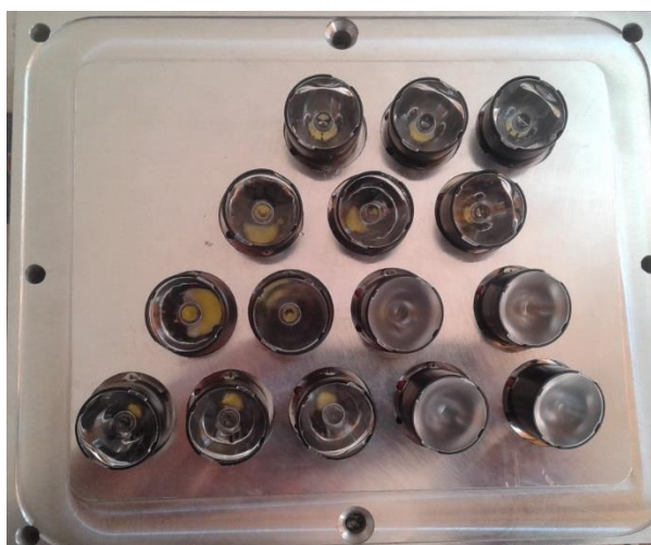
Фиг. 4.18. Вторична оптика на светодиодите с 6 и 10 градусови леци
