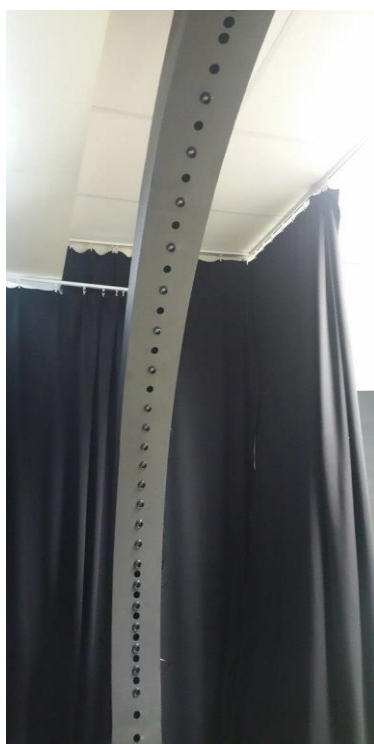
Фиг. 4.33. Дъгообразна греда с монтирани яркомери
