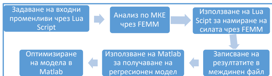
Фиг. 3.5 – Блокова схема на оптимизационния процес
