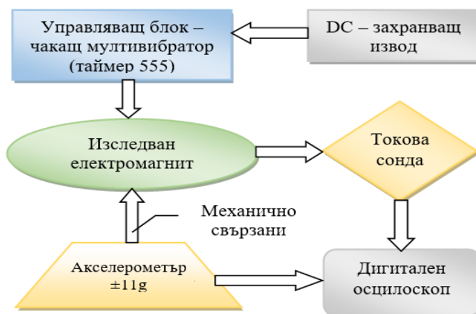
Фиг. 4.3 – Блокова схема на опитната постановка с акселерометър и токова сонда
