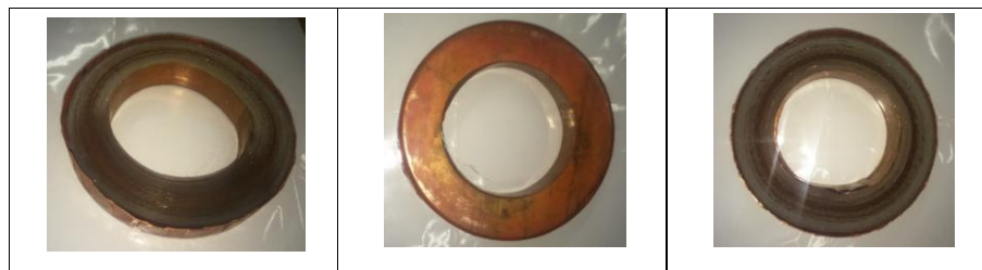
Фигура 2.5 Тороидален магнитопровод с едностранна метална чашка
