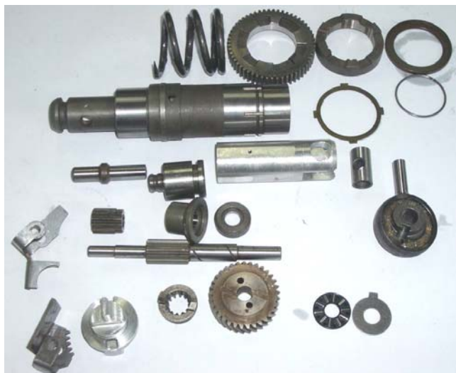
фигура 4.6 - Прототип с вграден оптимизиран пневматично-вакуумен ударен механизъм задвижван с променливотоков колекторен двигател
