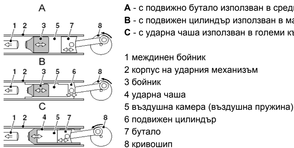
фигура 1.26 - Пневматично-вакуумен ударен механизъм
