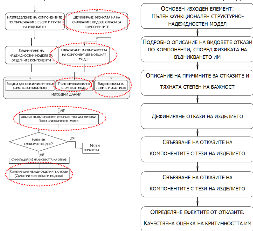
Фиг.4.2 Приложение на компонентите на функционалния структурно-надеждностен модел и системния подход за определяне надеждностните параметри при изготвяне на FMECA
