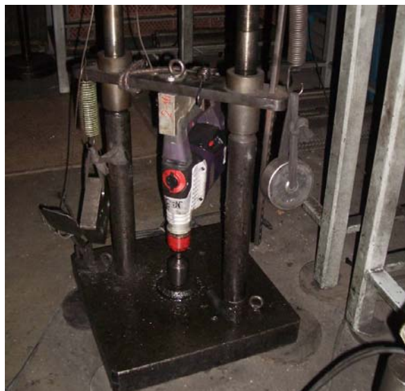
Фиг. 6.4 Изпитване на надеждност на перфоратор BP 330CE
