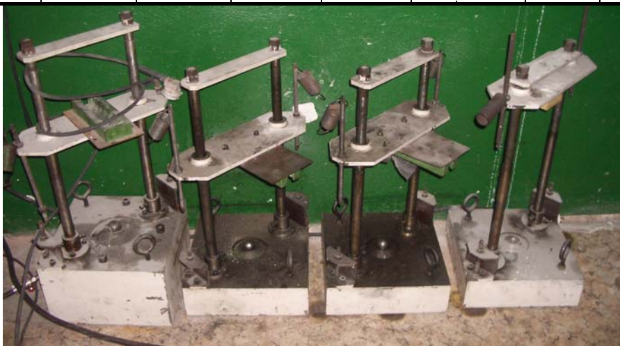
Фиг. 6.3 Изработени стандове за изпитване на надеждност на перфоратори и къртачи
