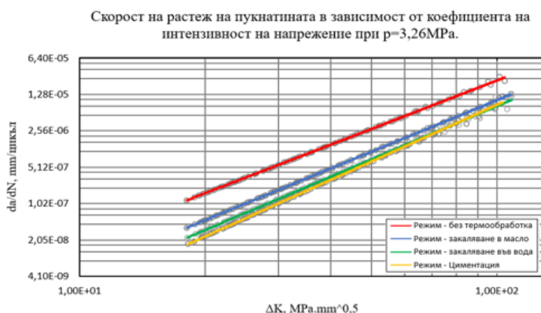
Фигура. 4.3 Визуализиране растежа на пукнатината в зависимост от \Delta K при p=3,26\text{MPa} .
