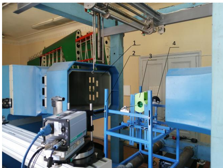
Фиг.4.11 Аеродинамична тръба УЛАК-1 с инсталиран модел на адаптивен ветрогенератор
