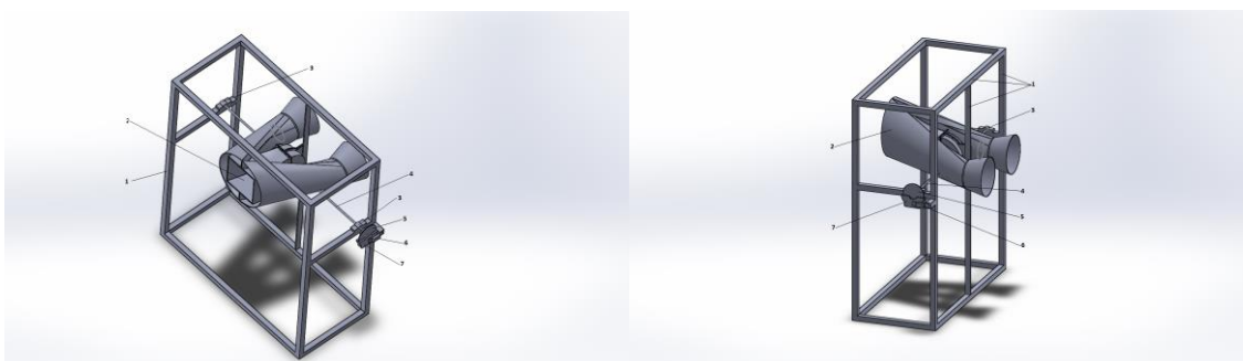
Фиг.4.7 Стенд за изследване на модели на адаптивни ветрогенератори
