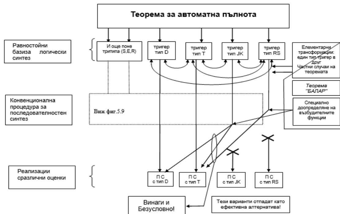
Фиг. 5.8 Етапи от процедурата при конвенционален последователностен синтез след прилагане на теоремата БАЛАР.
