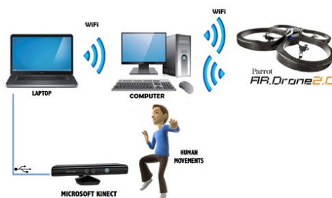
Фиг.4.11 Структура на двупосочна комуникация между дрон и управляващ компютър.
