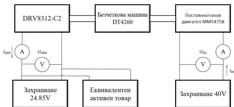
Фиг. 4.1. Блокова схема на опитната постановка за генераторен режим на работа на безчеткова машина DT4260
