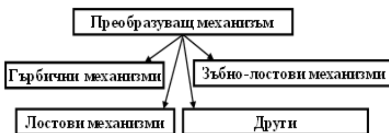
фиг.4 Класификация според типа на преобразуващият механизъм
