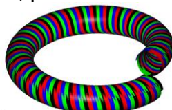
Фиг. 4.1.5. Траектории на 4 режещи зѐба разположени на различни централни ъгли, при обработване на цилиндрични повърхнини с въртящ се инструмент, когато заготовката и инструментът са с кръстосани оси.
