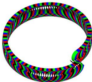
Фиг. 3.1.8. Получената челна повърхнина при струговане с фреза с 4 режещи зъба с дължина на режещия ръб l_{pc} , разположен по цилиндричната част на инструмента.
