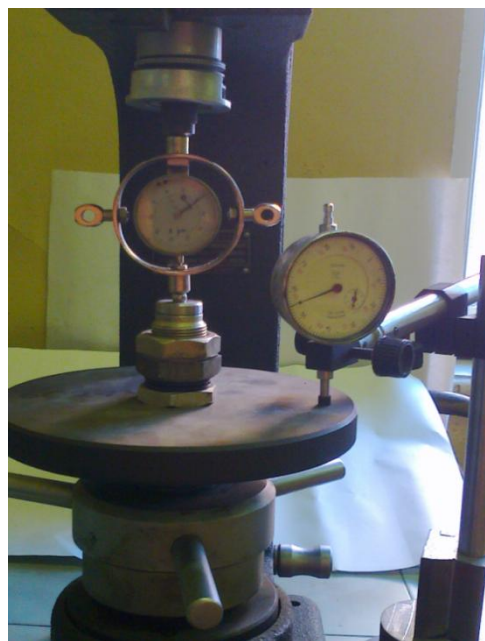
Фиг.3.21. Измерване на сила и деформация на пакет тарелчати пружини с динамометър и измервателна глава за линейни премествания.
