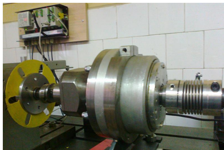
Фиг.4.25.образец-3.Предавка двустъпална с тарелчати пружини/схема А/.
