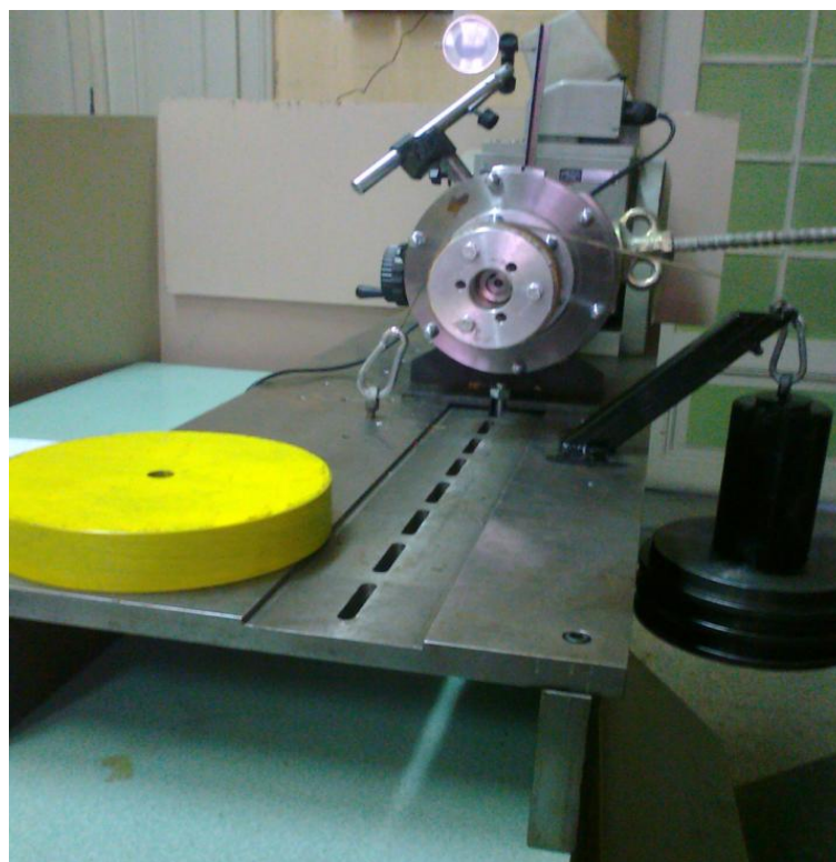
Фиг.4.15.а Стенд за статични измервания на ъглова коравина.
